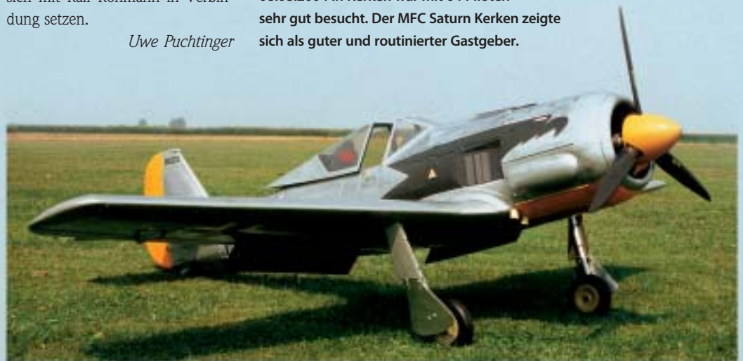
Diese Fw 190 von Andreas Muhle entstand aus einem Airworld-Kit und wird von einem 3W-120 Boxer angetrieben
